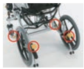
1箇所踏めばブレーキが掛かる全方向連動フットブレーキ！
